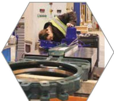
Montage et réglage de moteur électrique sur vanne à guillotine DN 500.
