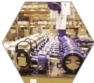
Vannes papillon équipées de vérin pneumatique double effet avec commande manuelle de secours.
